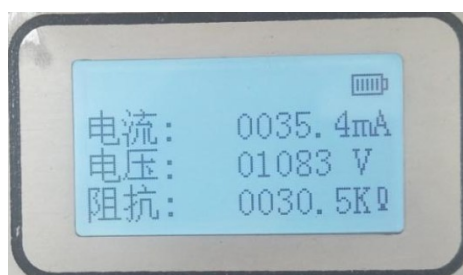
图 5-6 接地阻抗测量界面
