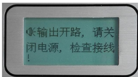
图 5-8 检测信号无法输出告警页面
